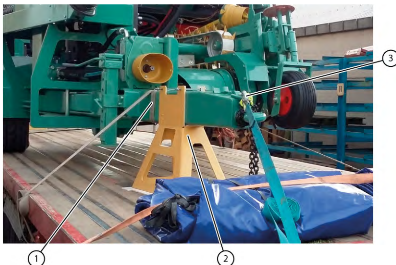
Fig. 35 Fixer la machine sur le camion (avant)
