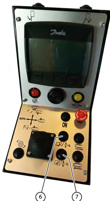
Fig. 65 Régler l'épaisseur de la nappe de lin avec la console de commande
